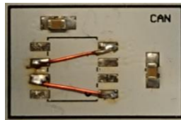
Figure 1: 更换 CAN 适配器
