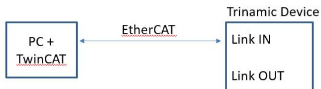
Figure 15: 连接 EtherCAT 主站和从站
